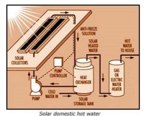
Figure 3.4.2.1: Solar domestic hot water<sup>12</sup>
